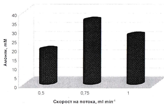
Фигура 20. Количество разграден 4-цианопиридин в зависимост от скоростта на потока 3 h след започване на процеса
