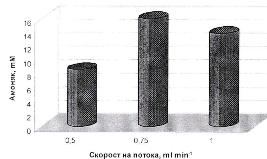
Фигура 23. Количество разграден бензонитрил при 55°C от биокатализатори получени по зол-гелен метод с 5 % PAAG.
