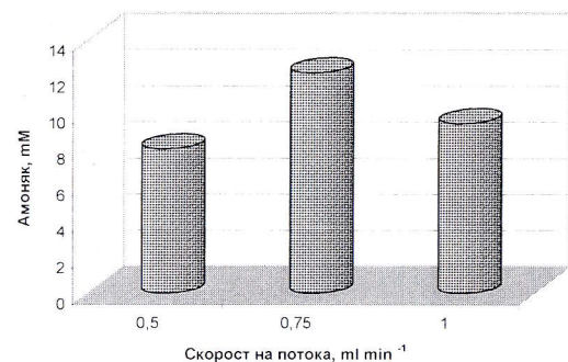
Фигура 19. Количество разграден бензонитрил при 45^\circ\text{C} в зависимост от скоростта на потока.
